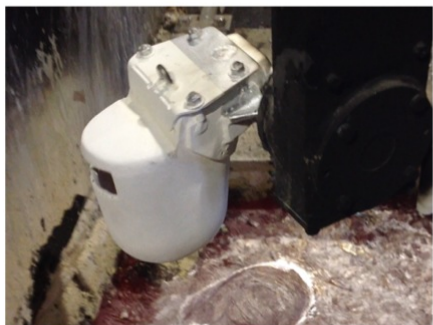
③陶瓷材質不腐蝕，表面特殊處理，正常下 不需塗附被覆劑。 /免保養，大幅節省時間與費用。
