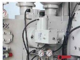
■ 射出電動フロコン 射出速度の調整を遠隔操作。 速度・昇圧時間の自動補正も行います。
