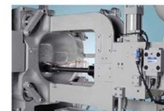
■ 压射部 C 型机架 压射部使用高强度的 C 型机架。由于射出油缸与料筒的孔是同时加工完成的，所以大大提高了压射部的可靠性。
