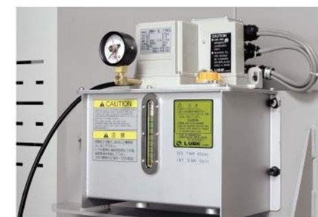
■ 肘节部润滑油自动润滑 高精度、高刚性的合模机构采用「定量供给润滑油自动润滑方式」。 使合模机构更可靠、更持久耐用。
