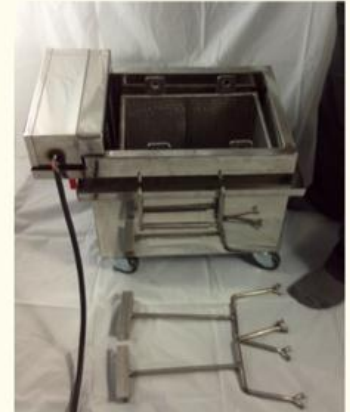
模具洗淨機及瀝乾吊掛架。
