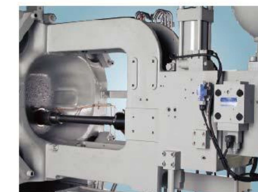
■ 压射部 C 型机架 压射部使用高强度的 C 型机架。由于射出油缸与料筒的孔是同时加工完成的，所以大大提高了压射部的可靠性。
