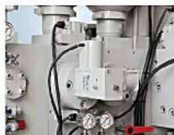
■ 射出电动流量阀 能够远距离调节压射速度。 也可进行速度与升压时间的自动补偿。
