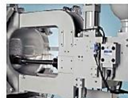
■ 压射部 C 型机架 压射部使用高强度的 C 型机架。由于射出油缸与料筒的孔是同时加工完成的，所以大大提高了压射部的可靠性。
