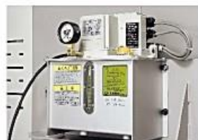
■ 肘节部润滑油自动润滑 高精度、高刚性的合模机构采用「定量供给润滑油自动润滑方式」。 使合模机构更可靠、更持久耐用。
