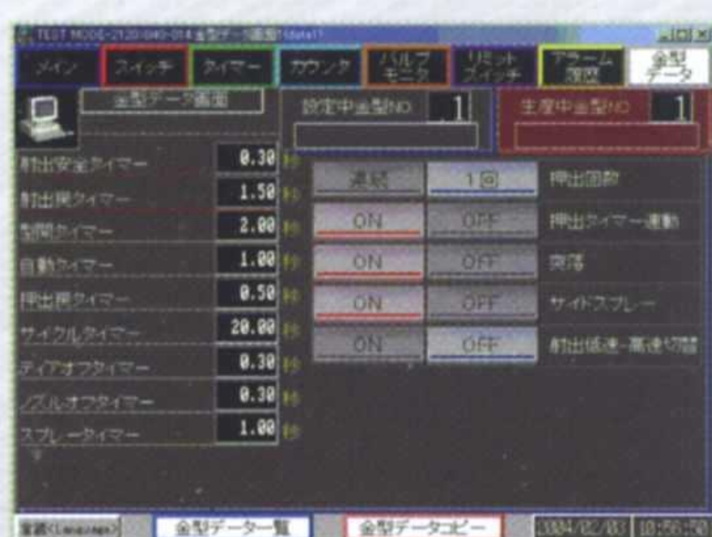
可储存20套模具生产设定数据，生产中更换模具时可轻松地设定压铸机的最佳生产设定值
