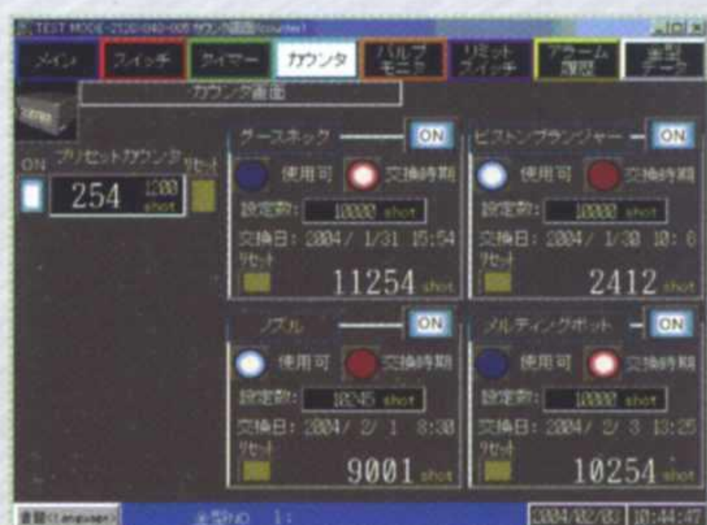
可记录各零件的更换日期及使用的压射数，有效地掌握零件的使用情况
