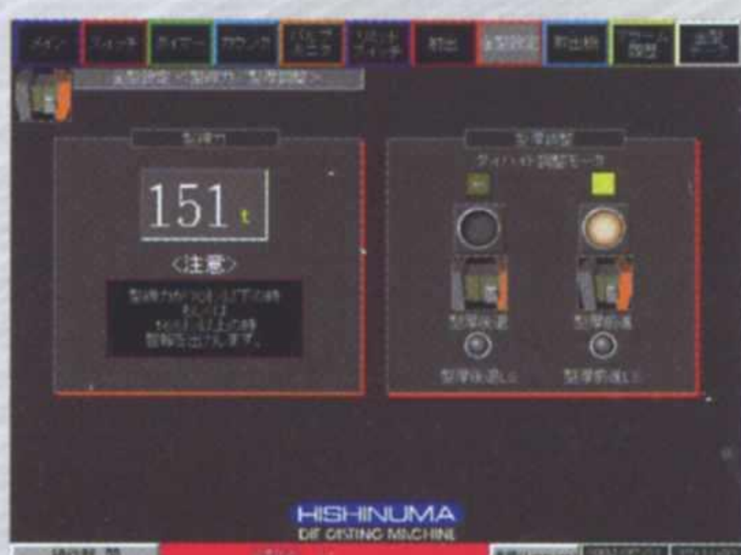
显示屏可准确显示锁模力。安装模具时可轻松调整。另外，此功能亦提供射出安全互锁信号，互锁确保压射安全
