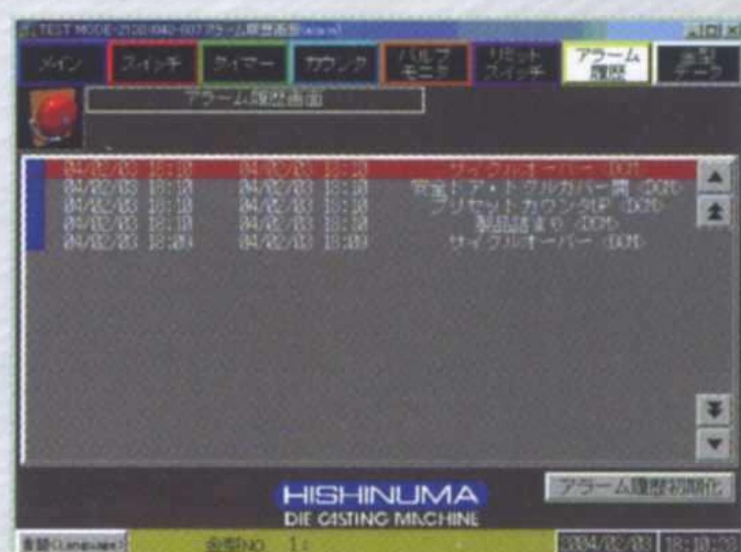
记录及显示压铸机及其外围设备的操作故障警报时间及原因
