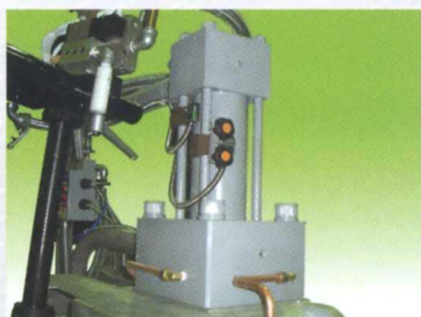
标准配置油缸外部附带式行程开关
