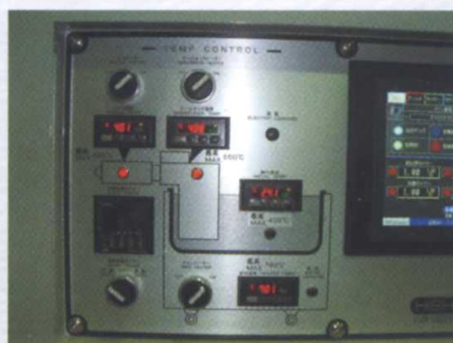
控制箱上设置图像化温度设定装置，各加热部分的设定及监查一目了然
