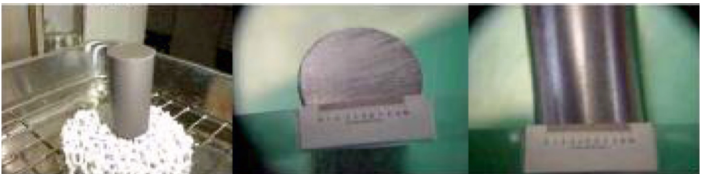
空气中冷却后 C-PRO 202 形成皮膜 包覆于表面
